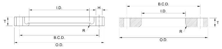
FIG. 4 DUCTILE IRON CONVOLUTED LJF/BUR
